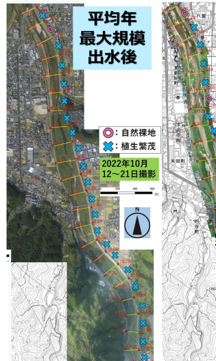
領域(a) 天神川7.0～11.4kpにおける植生繁茂・自然裸地存在領域の判定結果と平面2次元河床変動計算結果(平均年最大・既往最大規模)
