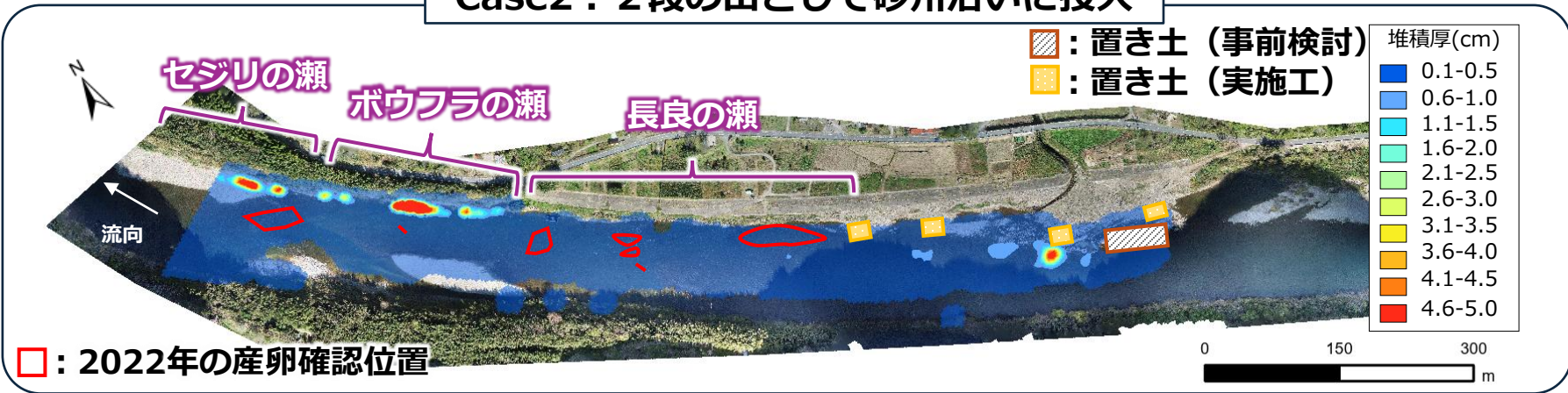
Case2：2段の山として砂州沿いに投入
