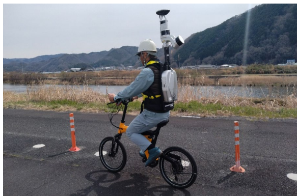
図-1 自転車走行によるLiDAR-SLAM観測
