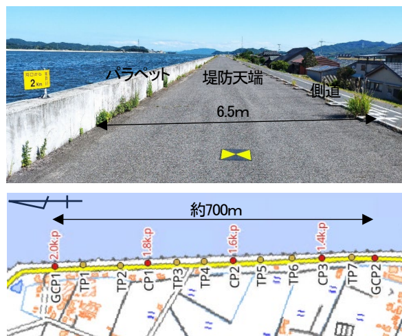
図-3 実地検証 (700m区間) のGCP/CPの配置状況
