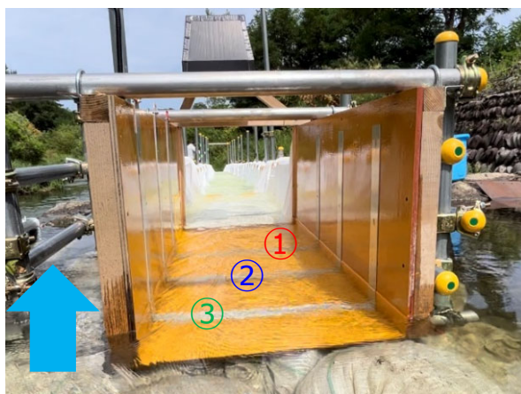
誘導水路内壁に電極を3つ設置
