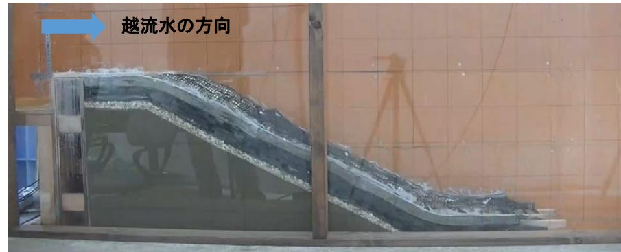
堤体の越水状況（ケース(d), 越流水深 h_t=0.10\text{ m} （0.50 m））（動画）
