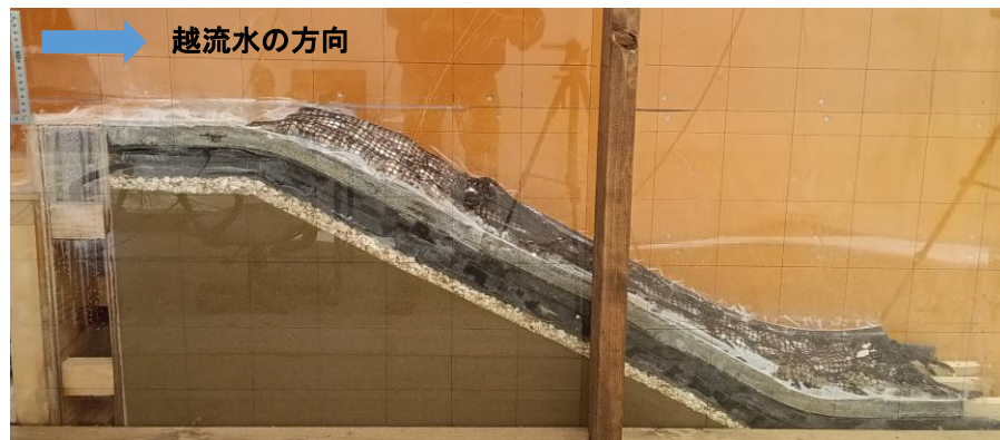
堤防模型の作製状況（ケース(d)）
