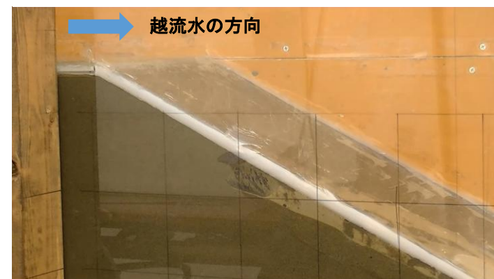
崩壊時の天端被覆工下面の状況（ケース(a)）（動画）
