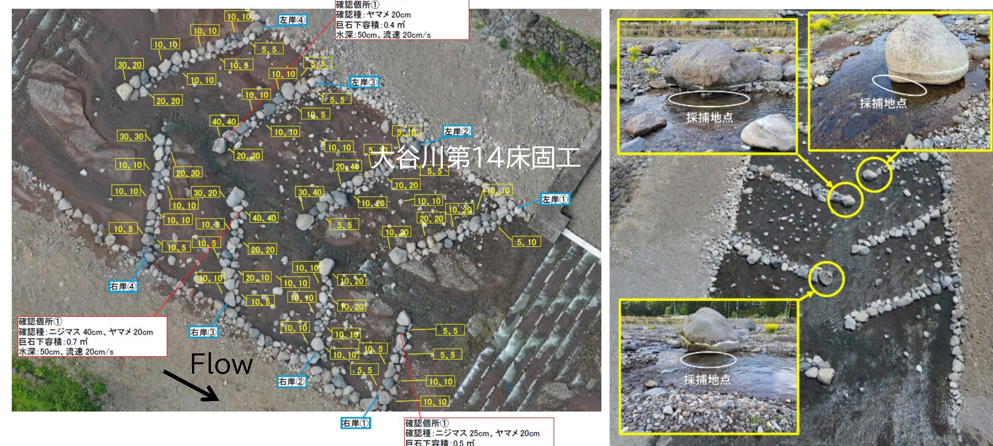
図4 (左)巨礫の下の空隙の流速・水深調査の一例(2025年7月実施) 数字は、水深(cm)・流速(cm/s)を示す (右)魚類の採捕地点の一例(2026年3月実施)
