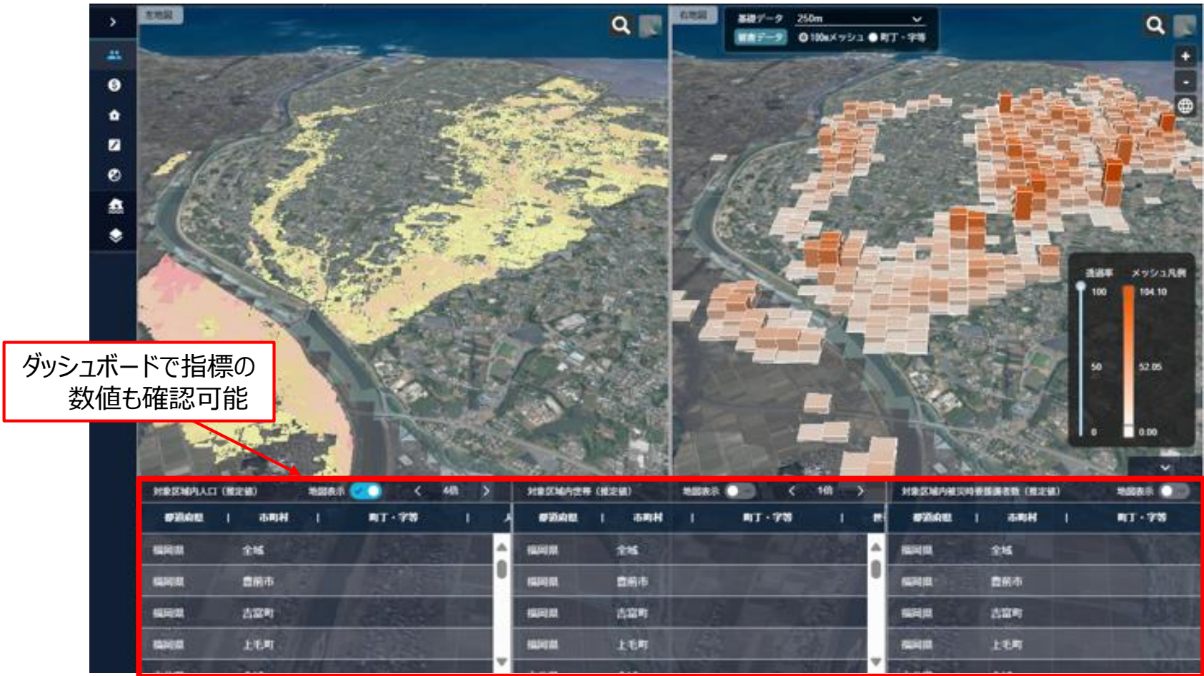
流域データ処理・可視化プログラムの表示例 (左：多段階浸水想定区域図、右：対象区域内人口)
