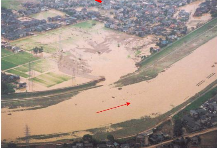
H16年洪水時 堤防破堤 (3.3km左岸)
