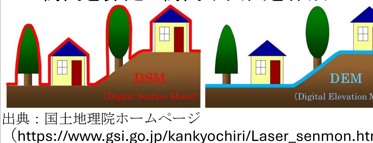
図-1 DSMとDEMのイメージ
