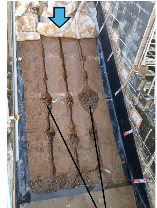
通水後の堤体洗掘状況 (通水30分後)
