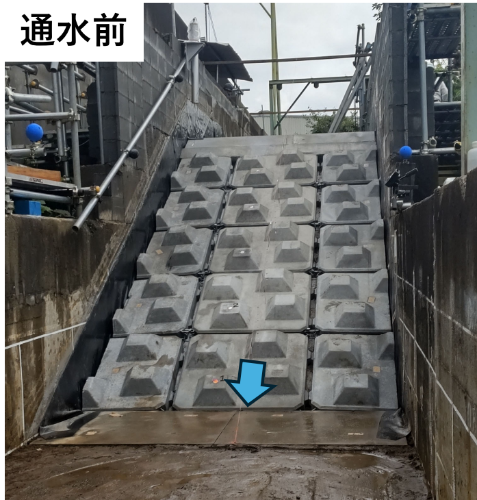
実測の通水前後の 堤体洗掘状況 (通水30分後)
