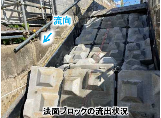
図 通水1時間後(ブロック崩落時)の土羽状況
