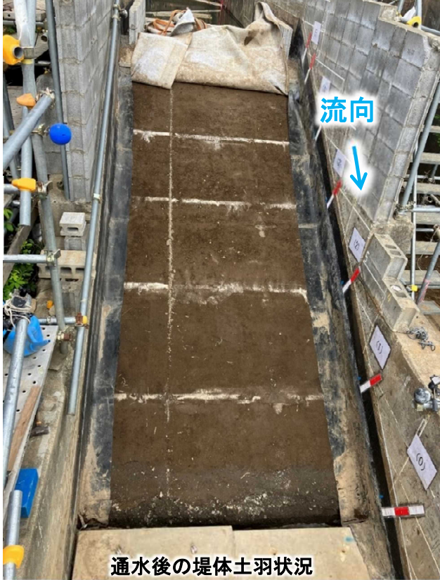
図 吸出し防止材による巻き込み状況
