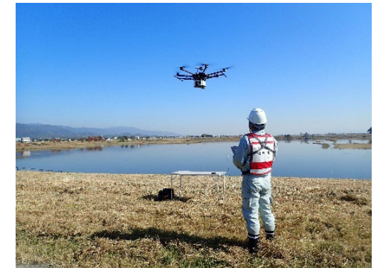
陸上・水中レーザドローン →国土交通省革新的河川管理プロジェクトによる開発機
