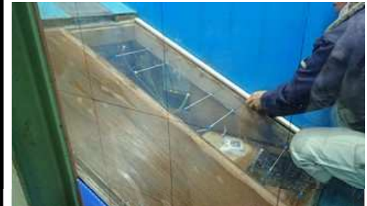
裏法面の一部はアクリル製 隙間の流れを模型内部から撮影可能
