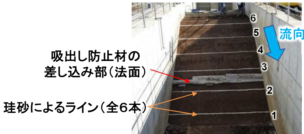
堤体土に珪砂でラインを引いた状況(通水前)
