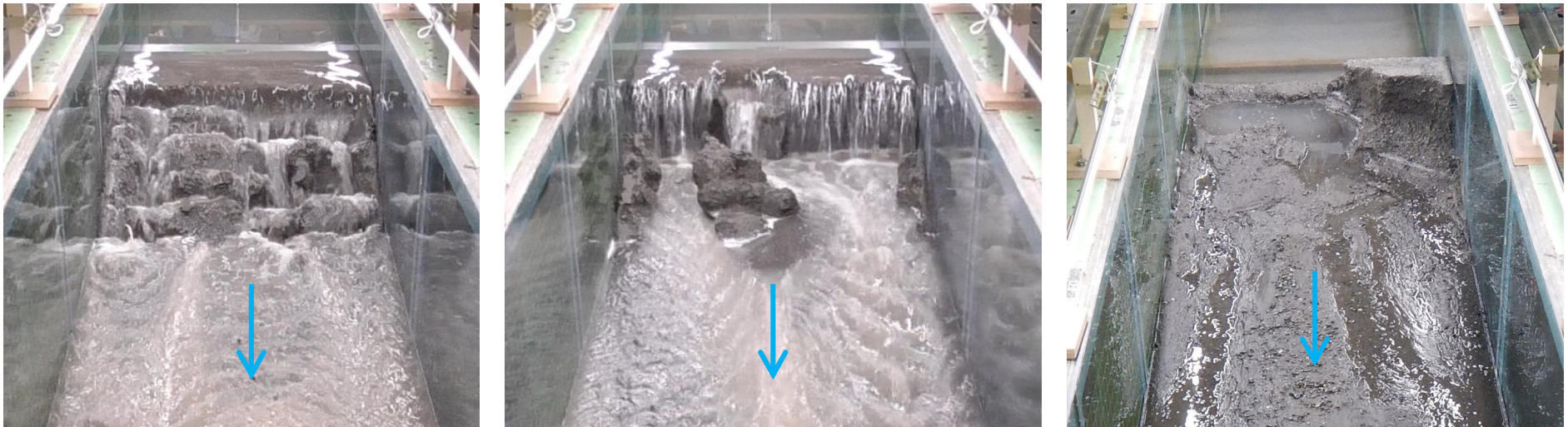
本実験1(裸堤)における堤体の侵食状況
