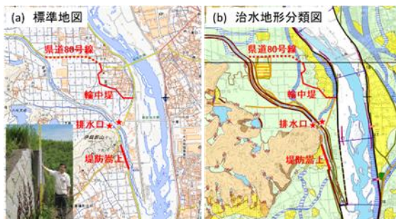
図-15 流域治水型超過洪水対策の施設配置
