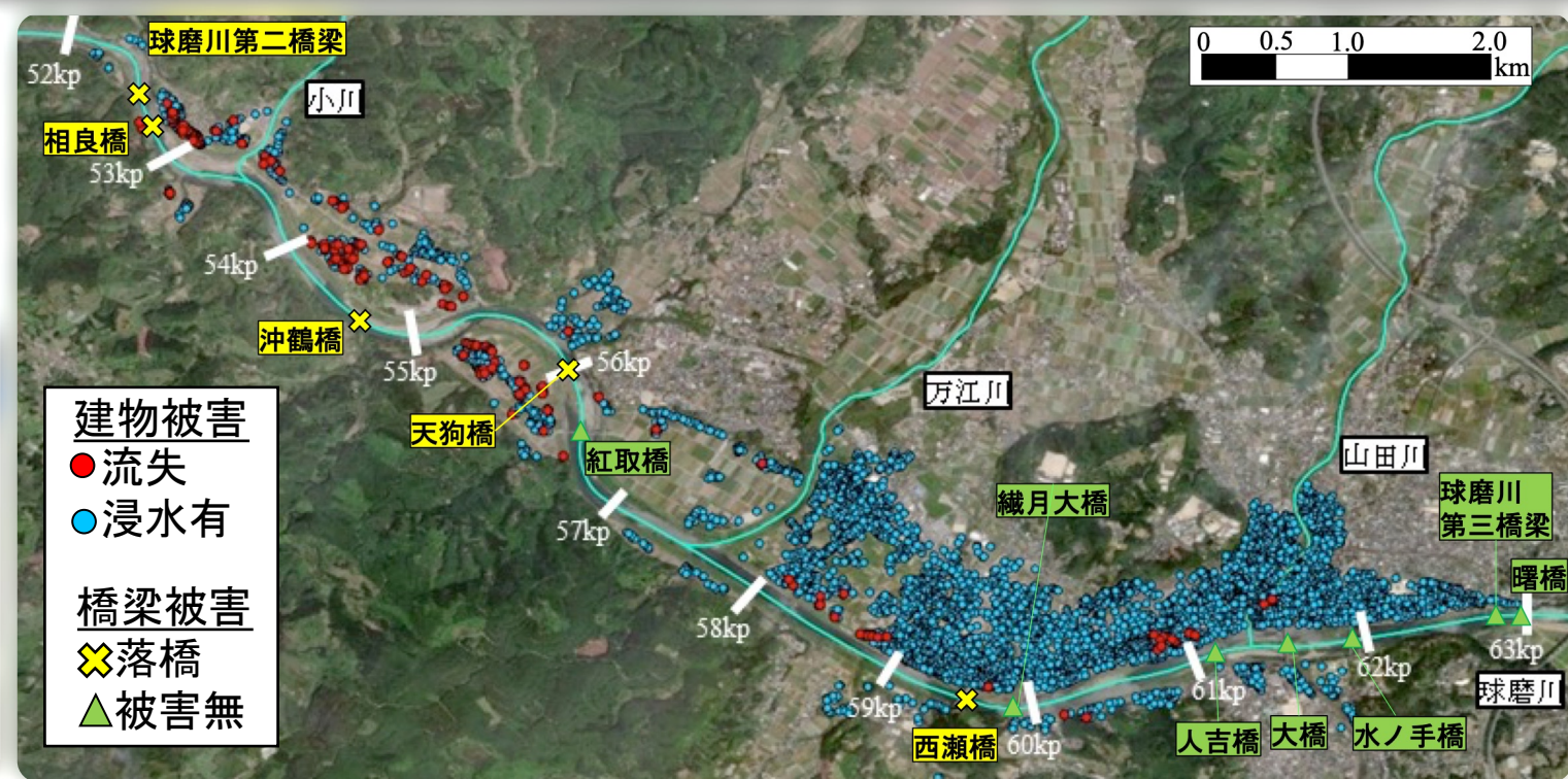
現地調査による建物・橋梁被災の平面分布
