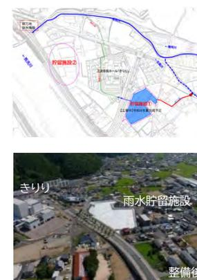
内水による浸水深を低下させるために、願万地地区において雨水貯留施設を設置。
