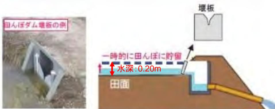
③ 雨量損失高の算定 ( $R_c = V/A$   $R_c$ :雨量損失高、 $V$ :貯留量、 $A$ :内水域面積)
