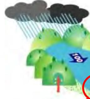
※2: 基本高水流量は、流域に降った計画規模の降雨が、そのまま河川に流れ出した場合の流量(ダムや遊水地等での洪水調節が行われていない状態の流量)。
